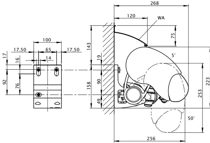
**Fijación a la pared con placas de fijación A**
